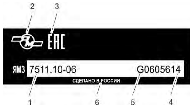
Рисунок 43 – Заводская табличка двигателя ЯМЗ-7511.10-06
