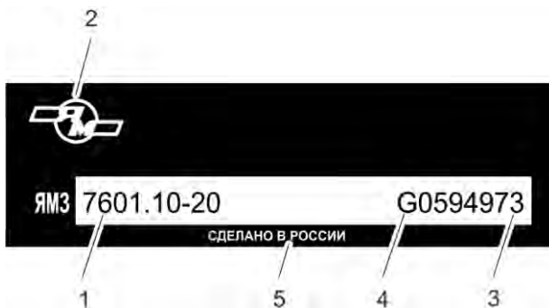
Рисунок 43а – Заводская табличка двигателя ЯМЗ-7601.10-20
