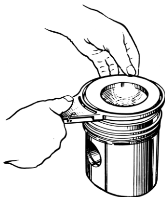
Рисунок 78 – Снятие и надевание поршневых колец на поршень
