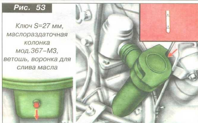
Рис. 53. Сменить масло в смазочной системе двигателя.
